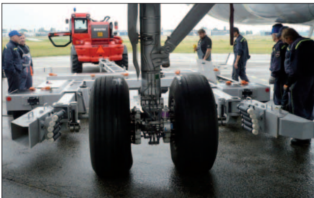
■ Letiště Praha disponuje dvojicí Recovery Dollies použitelných v případě poškození nebo zničení podvozkových kol
