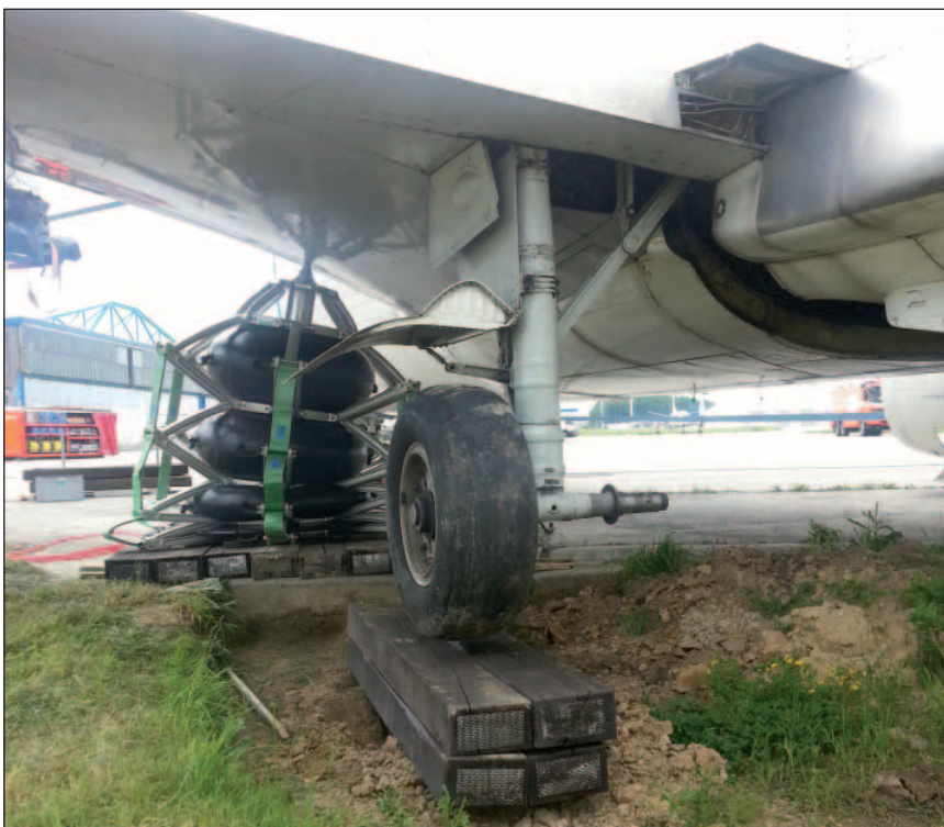
■ Vysokotlaké vaky umožňují zvedat letadla i v jejich podpěrných bodech
