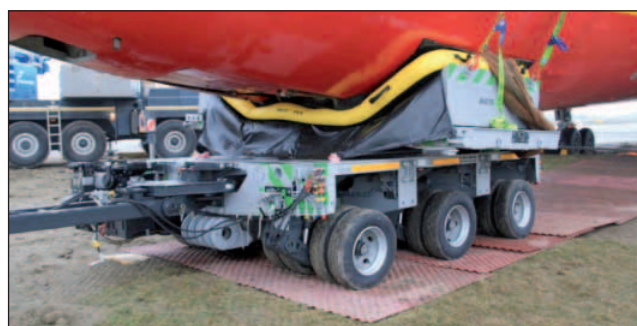
■ Airbus A300-400 uvízlý v Bratislavě a jeho vyproštění pomocí nafukovacích vaků a transportního traileru
