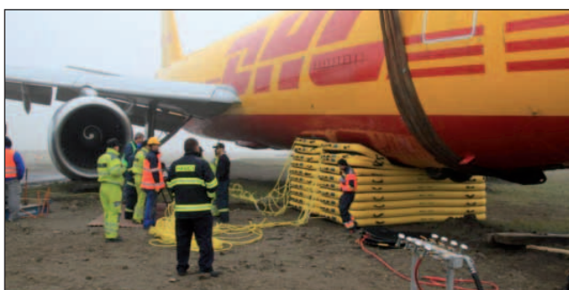
■ Airbus A300-400 uvízlý v Bratislavě a jeho vyproštění pomocí nafukovacích vaků a transportního traileru
