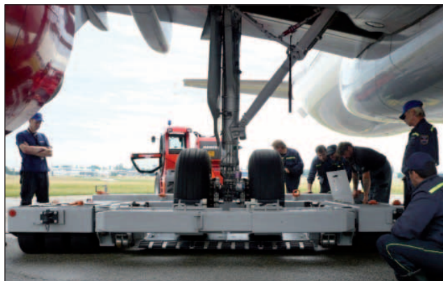
■ Letiště Praha disponuje dvojicí Recovery Dollies použitelných v případě poškození nebo zničení podvozkových kol
